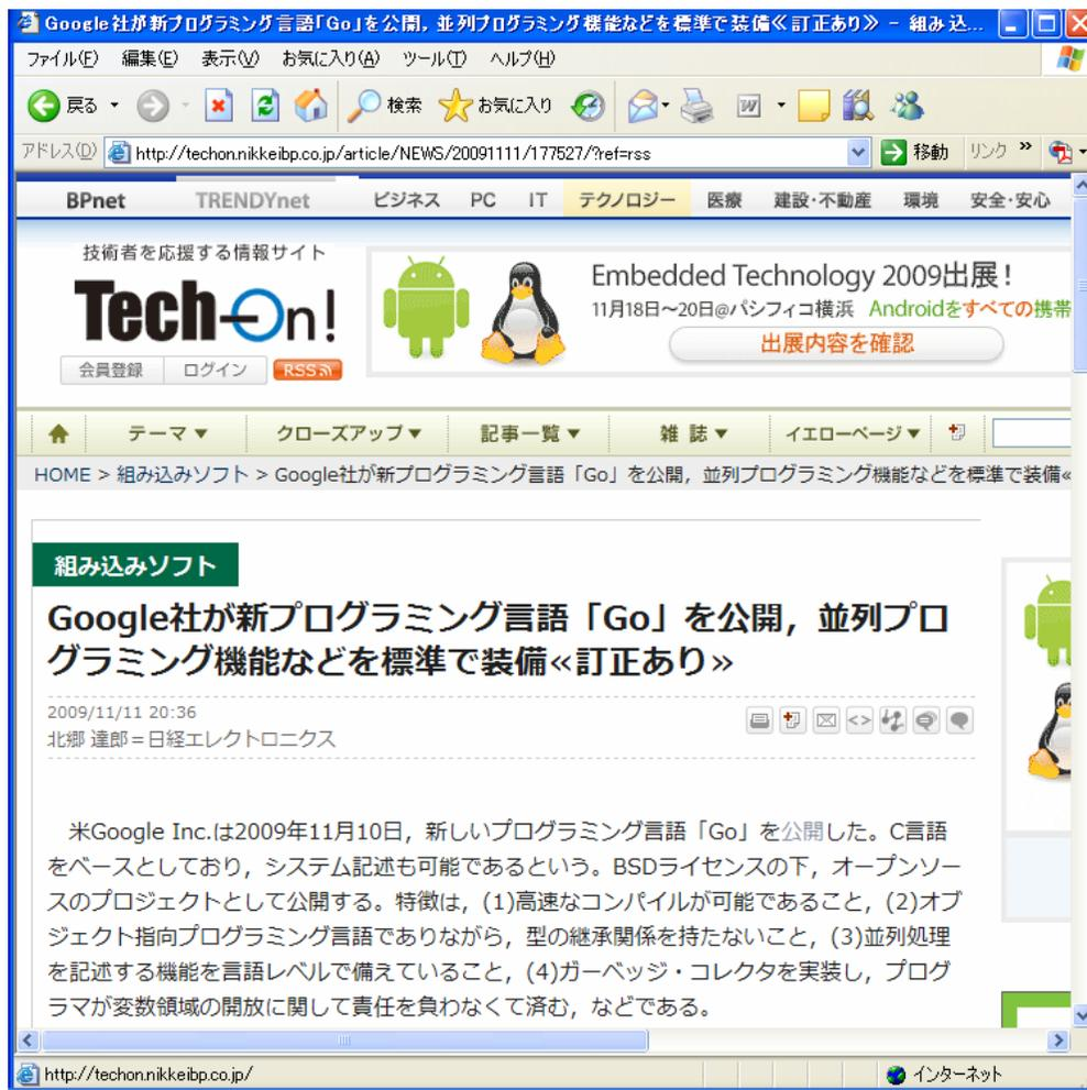
(3)の並列処理の記述は，CSP (communicating sequential process)と呼ぶプロセス代数のモデルに基づいている。CSPは1978年にTony Hoare氏が提案した考え方で，データの入出力を一つのアトミックな操作として定義するというもの。共有データを持たないことで，ロックやセマフォといった同期のメカニズムを使わずに並列処理を記述できる。
