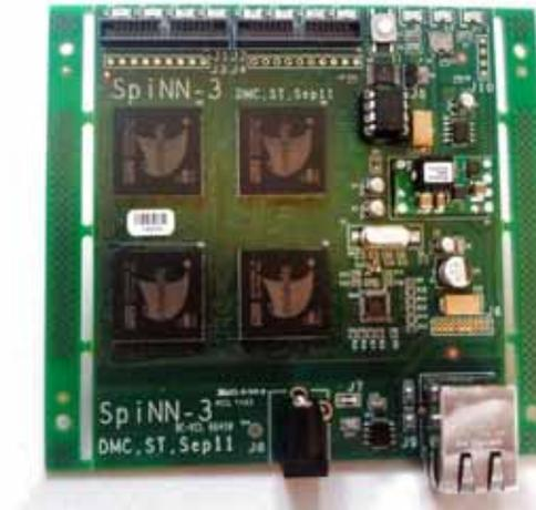
SpiNNaker chipは人工知能に特化したNoC(Network-on-Chip)で、ニューラルネットを基本とした超並列コンピューティングです。コアにはARM9のMPUが採用されています。ワンチップに18個のコアが搭載されています。ノード数が4つのボードで72個のARMプロセッサが搭載されています。将来的にはこのモジュールが他のモジュールと接続され、筐体の中に収められる予定で、最大で何と**1,036,800個**のプロセッサコアが搭載されるようです。これだけ大規模なシステムのボード間、筐体間の通信は同期通信だと困難です。同一のクロック領域だけに同期通信を採用しています。異なったクロック領域はチャンネルで接続されます。ここでは**GALS** (Globally Asynchronous Locally Synchronous)の通信方式を採用しています。GALSは一般的にCSPモデルの拡張として知られています。
